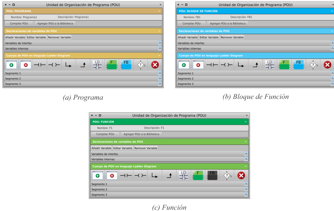
Figura 3.16: Ventanas de edición de “Unidad de Organización de Programa (POU)” para los tipos de POU: (a) Programa, (b) Bloque de Función y (c) Función.
