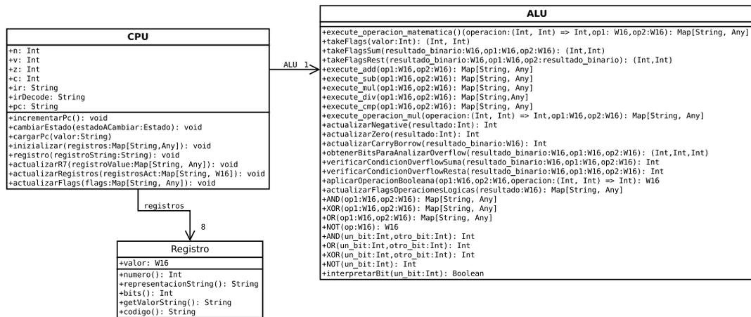
Figura 2.3: Diagrama de clase de la CPU
